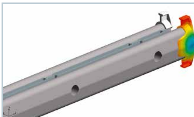
Bild 1. Die Klammer arretiert einen Korb auf einer Laufschiene. Für die Montage sind die Einbaumaße exakt einzuhalten
