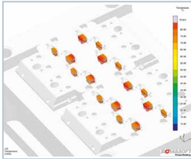
Bild 3. In den Schieberkernen bilden sich Hotspots mit Temperaturen über 70 °C (© Sigma Engineering)
